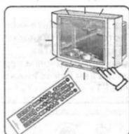
3. Сначала нажимают кнопку «Настройки», не отжимают, потом нажимают кнопку «Источника электропитания» до тех пор, пока светится рабочая показательная лампочка, потом отжимают.
